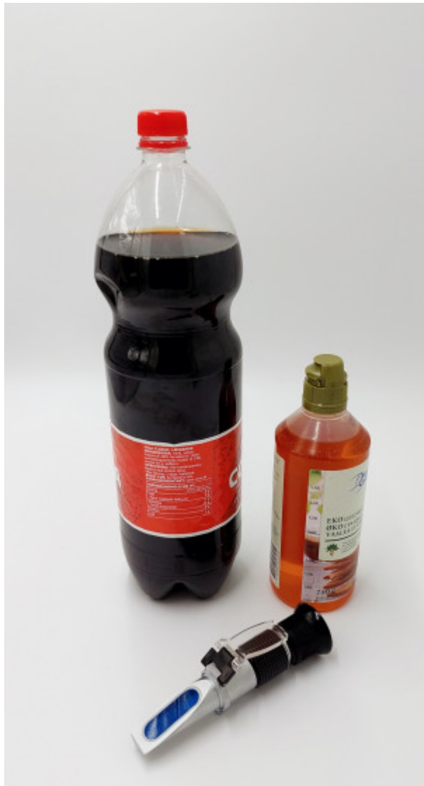
Foto: Et refraktometer kan anvendes til de fleste væsker. Det er mest praktisk til måling af brydningsindeks for høje sukkerkoncentrationer.
